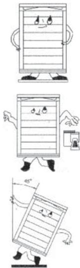
Instale sua Cave num piso que seja forte o suficiente para suportá-la, quando ela estiver completamente carregada. Não a coloque sobre uma superfície macia como espuma plástica por exemplo. Também não situe próximo da Cave nenhum objeto que possa provocar eco. Para nivelá-la, ajuste os pés frontais.
