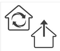
Funciona com depuração, devolvendo ao ambiente o ar purificado e higienizado, ou também na função exaustora, que retira o ar sujo e contaminado do ambiente.
